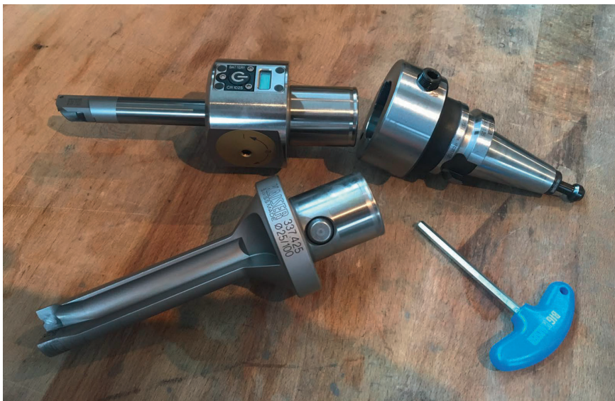
2 Eine Schraube genügt, um den Werkzeughalter auszutauschen. Er ist Teil eines modularen Systems, mit dem Hera unter anderem verschiedene Werkzeuge, Verlängerungen und Aufnahmen kombinieren kann (© BIG Kaiser)
