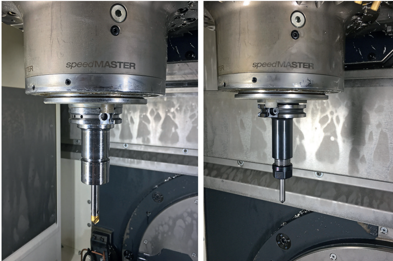
1 Eine SpeedMaster-BDV40-Spindel mit BIG-Plus-Werkzeugaufnahme (links) und eine Standard-SK40-Werkzeugaufnahme auf einem der Bearbeitungszentren bei Hera (© BIG Kaiser)
